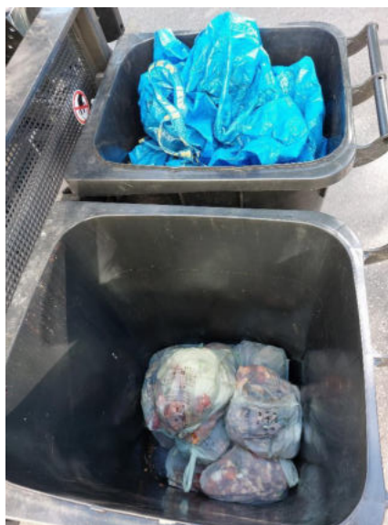
11. és 12. ábra: A gyűjtő járművön 2 tartály van. A gyűjtőszolgálat az egyikbe a konyhai szerves hulladékot, a másikba pedig a zsákokat helyezi. A kék zsákokat kimossák, és többször használják.
